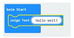
Überprüfe die Funktion im Simulator und speichere das Programm. Lade dann das Programm auf das micro:bit Board herunter.
